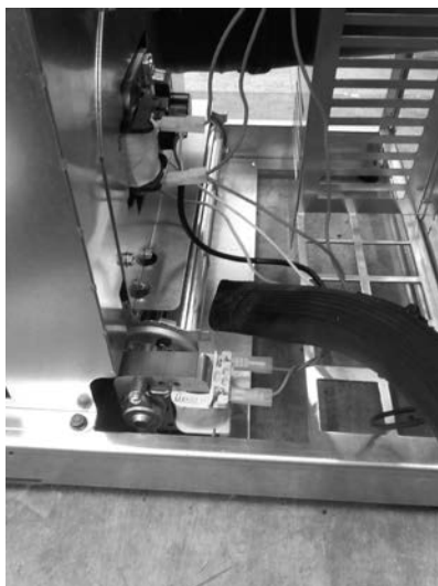
Fig. 72 - Limpeza do ventilador ambiente
