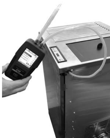
Fig. 61 - Ligação do pressóstato digital
