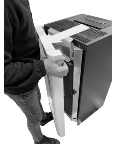
Fig. 29 - Remover a moldura
