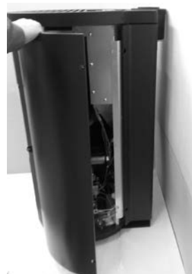
Fig. 46 - Desencaixar as partes laterais
