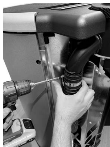
Fig. 54 - Remova o tubo flexível
